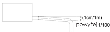
Grafika 6.1 Wymagane minimalne nachylenie rury spustowej
