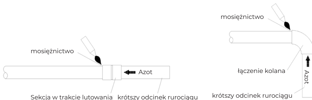
Grafika 5.5 Przepływ azotu z krótszego boku podczas lutowania
